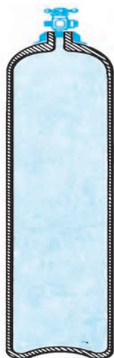
کپسول فولادی مخصوص برای ذخیره اکسیژن
