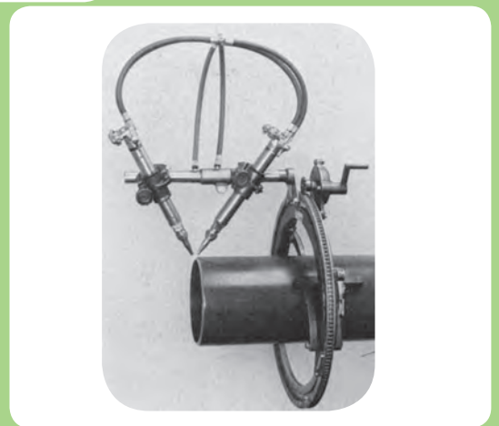
برشکاری و پخ‌سازی لوله فولادی به‌طور هم‌زمان
