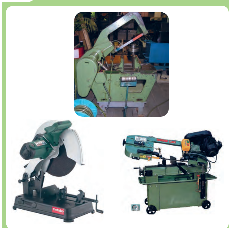
انواع متداول اهر که برای برشکاری قطعات فلزی استفاده می‌شوند
