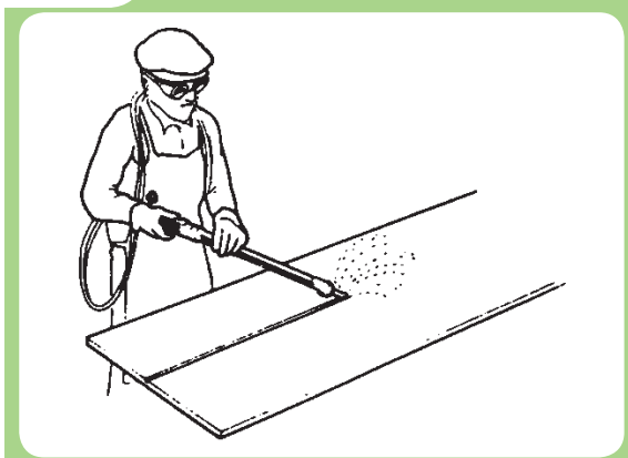
اجرای عملیات برشکاری با مشعل دستی
