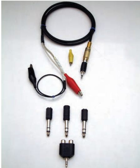
شکل ۳-۵۵- نحوه‌ی ساخت فیش رابط برای دریافت خروجی از دستگاه پخش صوت به صورت مونو
