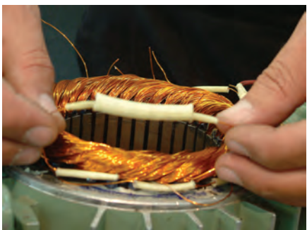
شکل ۴-۱۰- قرار گرفتن قسمت اتصال یافته (لحیم کاری شده) روی سیم ها
