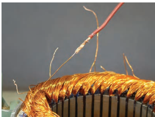
شکل ۴-۱۱- اتصال سیم‌های افشان به سیم‌های لاک‌ی
