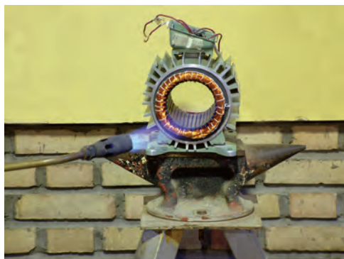
شکل ۲-۱۸- سوزاندن مستقیم سیم‌ها با شعله
