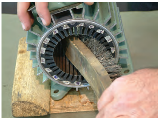
ب – تمیز کردن استاتور با برس سیمی
