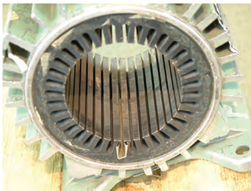
شکل ۲-۳۶ – آزمایش عایق در داخل شیار
