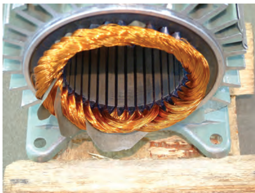
شکل ۲-۳۱- عایق کاری پیشانی کلاف‌ها
