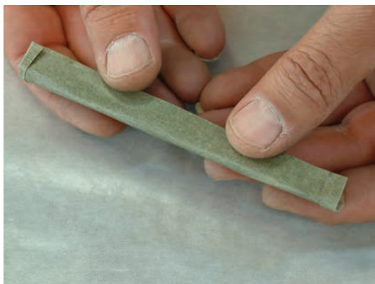
ب- تا کردن و فرم دادن عایق برشمان شکل ۲۷-۲
