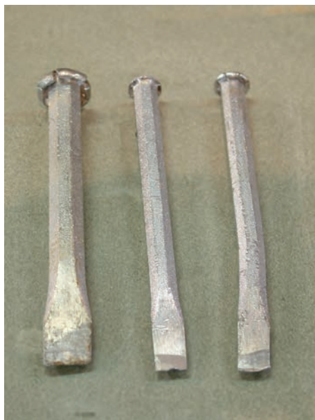
شکل ۲-۱۹- چند نمونه قلم برای بریدن سیم‌ها
