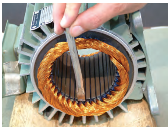
الف- قرار دادن قلم روی سیم‌ها
