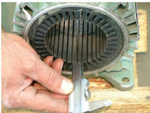
شکل ۲-۳۲- اندازه گیری طول شیار
