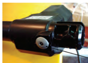
خلاص کن درب اتوماتیک لولایی که توسط آچار مخصوص (آلن) باز میشود
