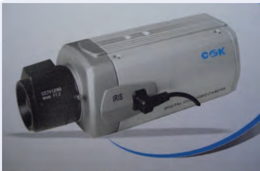
شکل ۳-۲۲ اتصال کابل لنز اتوایریز به دوربین
