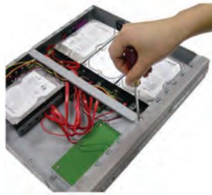
شکل ۳-۶۸ دیسک سخت نصب شده در داخل دستگاه
