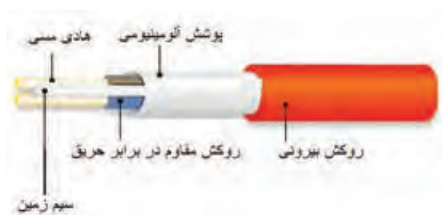
شکل ۱-۲۴ قسمت‌های مختلف یک کابل اعلام حریق
