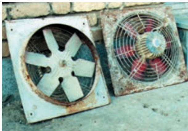
تعویض هواکشهای خراب و فرسوده
