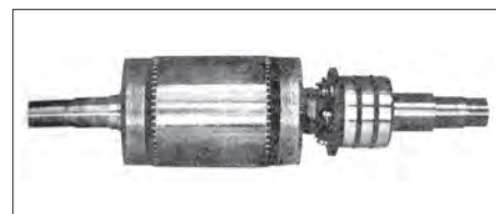
شکل ۱۵- شکل واقعی روتور سیم پیچی شده
