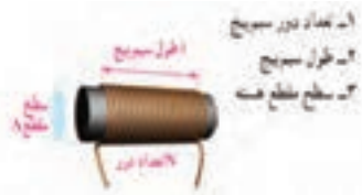
شکل ۸-۳- پارامترهای مهم در یک سلف
