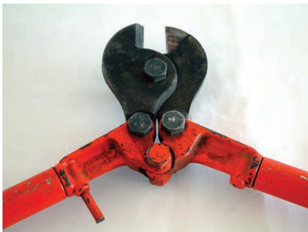
شکل ۵-۷۳- قیچی کابل بری
