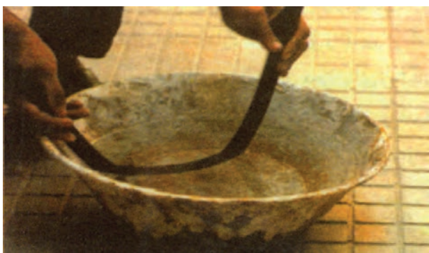
شکل ۴-۴۵ - سرد کردن لوله پس از خم‌کاری
