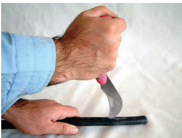
شکل ۳۲-۵- روکش برداری غلط
