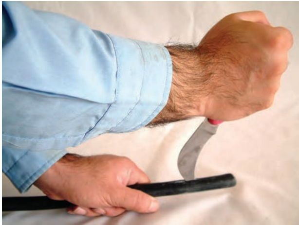
شکل ۵-۳۳- طریقه‌ی صحیح روکش برداری کابل
