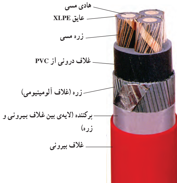
شکل ۵-۷- کابل با غلاف آلومینیومی
