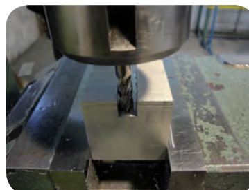
شیار تراشی با تیغه فرز انگشتی
