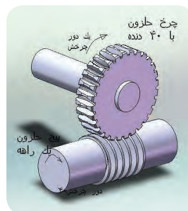
سیستم چرخ حلزون و پیچ حلزون
