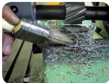
نحوه دور کردن براده ها
