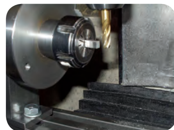
چهارگوش کردن قطعه به کمک دستگاه تقسیم
