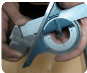
کنترل شیب قطعه با زاویه سنج انیورسال
