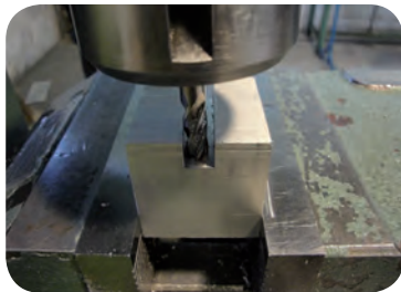
جابجایی تیغه فرز انگشتی برای افزایش پهنای شیار
