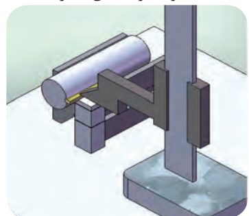
اندازه گیری عمق شیار
