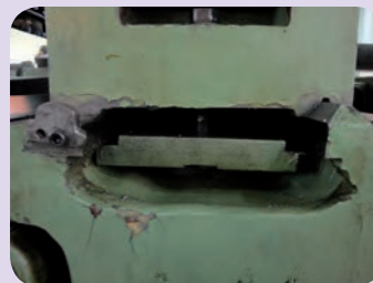
شیار دم چلچله ای بستر ماشین تراش
