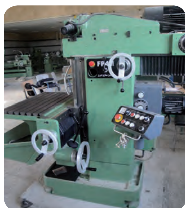
فلکه های دستگاه برای جابجایی دستی
