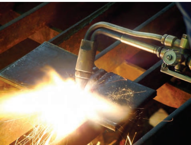
شکل ۲-۶- برشکاری با گاز
