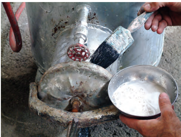
شکل ۲-۳۹- کنترل نشتی گاز
