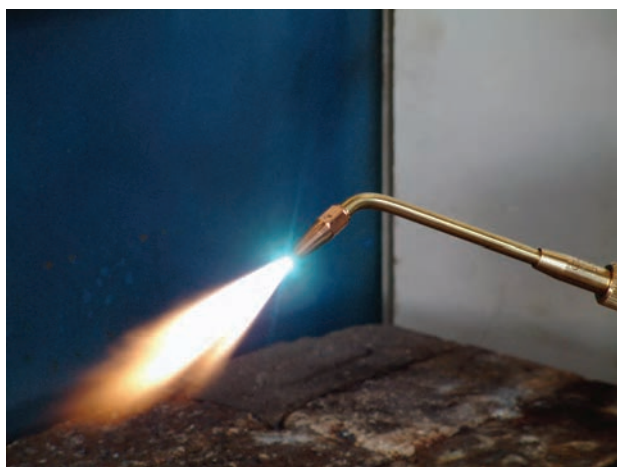
شکل ۲-۳- شعله‌ی سوختن گاز استیلن با اکسیژن
