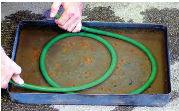
شکل ۲-۹۹- کنترل نشتی شیلنگ در آب
