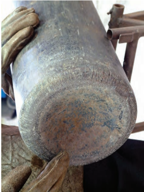
شکل ۲-۱۸- گودی ته کپسول اکسیژن
