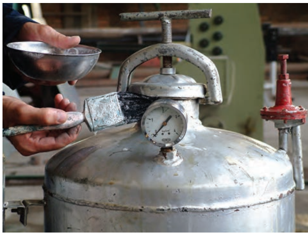
شکل ۲-۳۸- کنترل نشتی گاز
