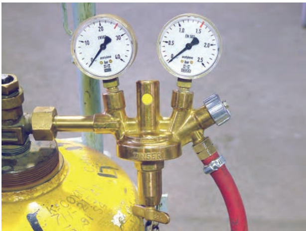
شکل ۱۳۵-۲ پیچ تنظیم فشار استیلن روی رگولاتور
