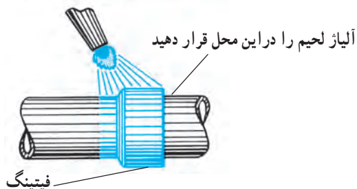
شکل ۴-۱۹- ترتیب گرم کردن لوله و فیتینگ
