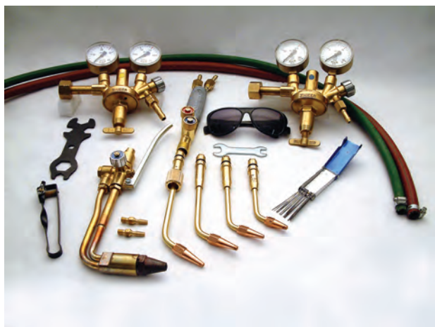
شکل ۱۵-۲ - تجهیزات جوشکاری با شعله‌ی گاز
