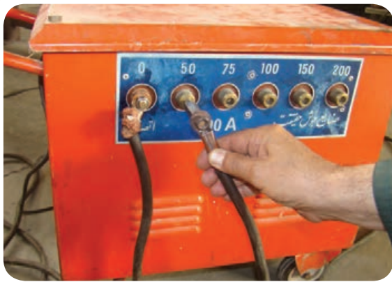
تنظیم آمپر در دستگاه ترانسفورماتور پله‌ای
