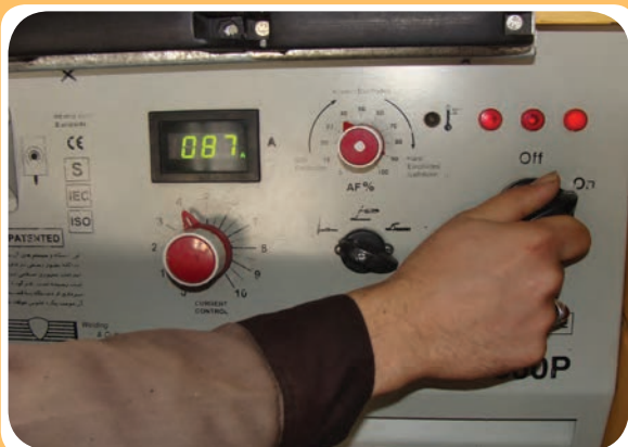
کلیدهای مختلف روی صفحه اصلی رکتی‌فایر جوشکاری
