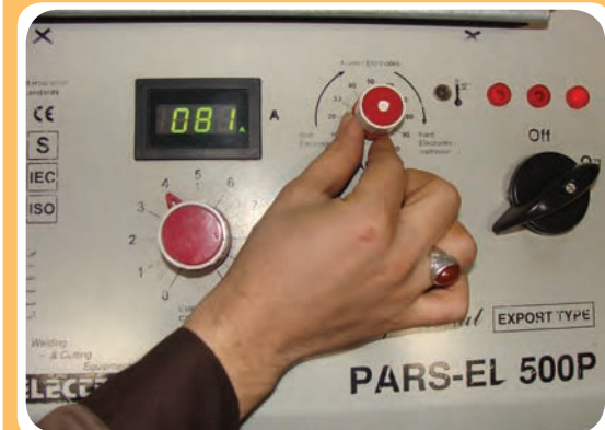
کلید انتخاب جریان مناسب بر حسب نوع الکتروود جوشکاری
