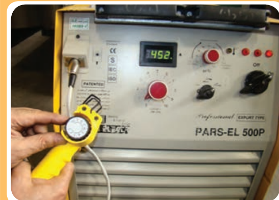
تنظیم آمپر از کنار دست جوشکار توسط سیستم کنترل از راه دور
