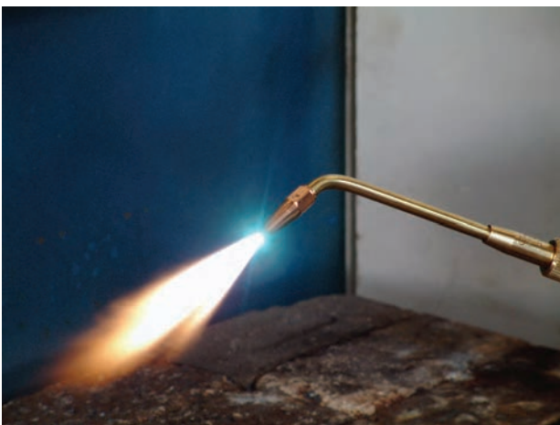
شکل ۲-۳ - شعله‌ی سوختن گاز استیلن با اکسیژن
