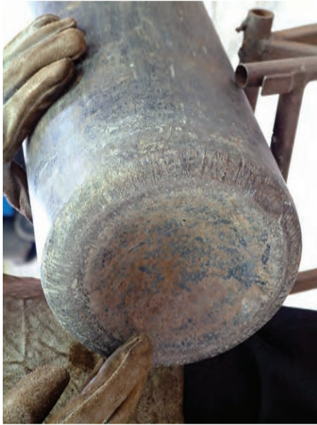
شکل ۲-۱۸- گودی ته کپسول اکسیژن
