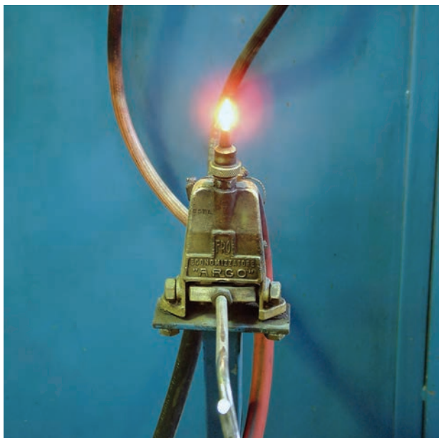
شکل ۲-۶۸- شمعک روی میز جوشکاری گاز
