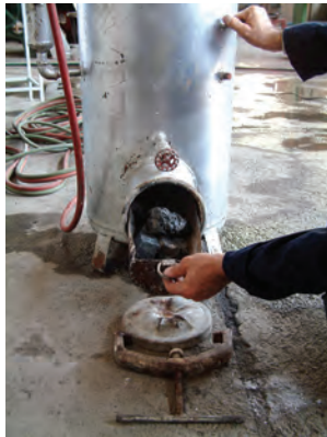
شکل ۲-۳۴ - قراردادن کاربید در محفظه‌ی مخصوص
