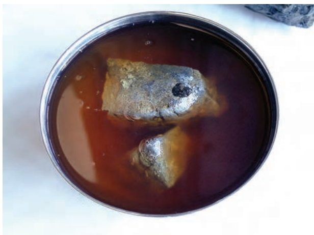
شکل ۱۲-۲ نگهداری کاربید در زیر نفت
