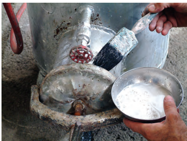
شکل ۲-۳۹- کنترل نشتی گاز
