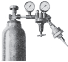
شکل ۲-۴۴- شیر یک طرفه بعد از رگولاتور
