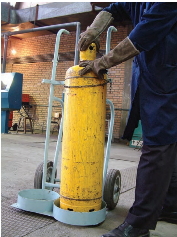
شکل ۲-۱۹- کپسول استیلن و کلاهک آن
