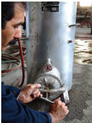
شکل ۲-۳۶ - بستن دریچه‌ی محفظه‌ی کاربید
