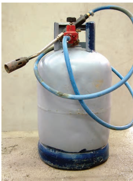
شکل ۱۳-۲ کپسول و رگولاتور بوتان
