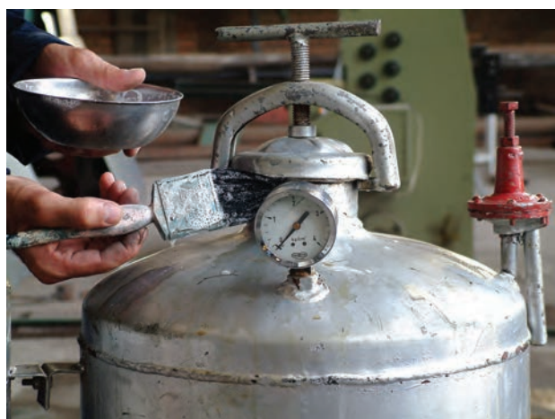
شکل ۲-۳۸- کنترل نشتی گاز
