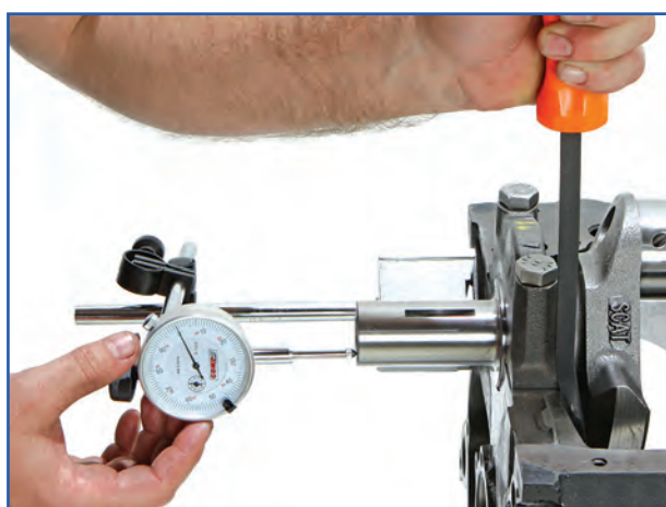
شکل ۱۷۹-۴- اندازه‌گیری لقی طولی میل‌لنگ با ساعت اندازه‌گیری
