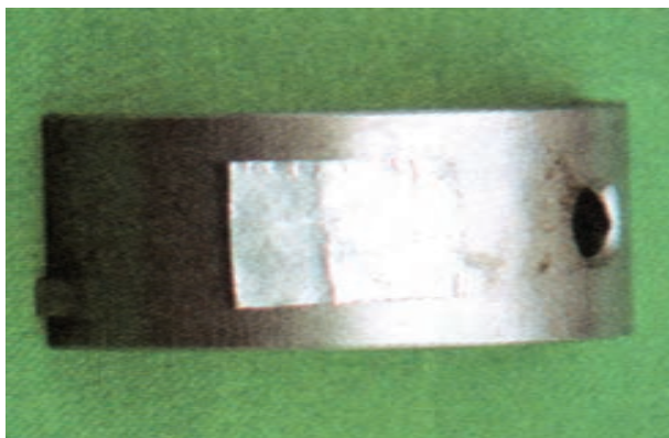
شکل ۱۷۴-۴ قرار دادن لایه با ضخامت مناسب پشت یاتاقان
