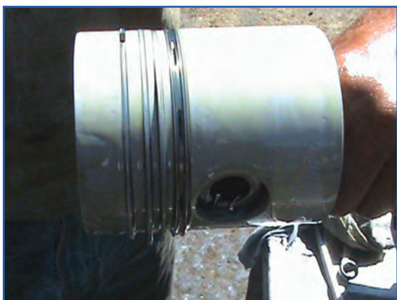
شکل ۱۴۰-۴- روغن‌کاری همه رینگ‌ها و پیستون
