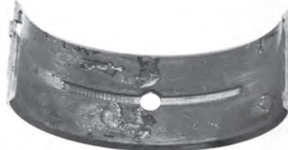
شکل ۱۶۷-۴ نقاط ذوب‌شده روی یاتاقان
