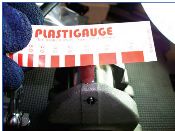
شکل ۱۷۶-۴- اندازه گیری دو بهنی پلاستی گیج شابلون
