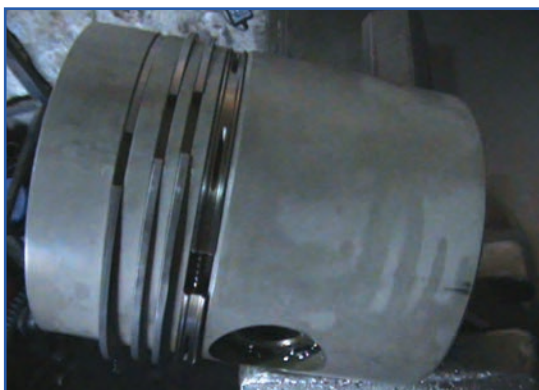
شکل ۱۳۹-۴- ترتیب قرار گرفتن رینگ‌ها روی شیار پیستون
