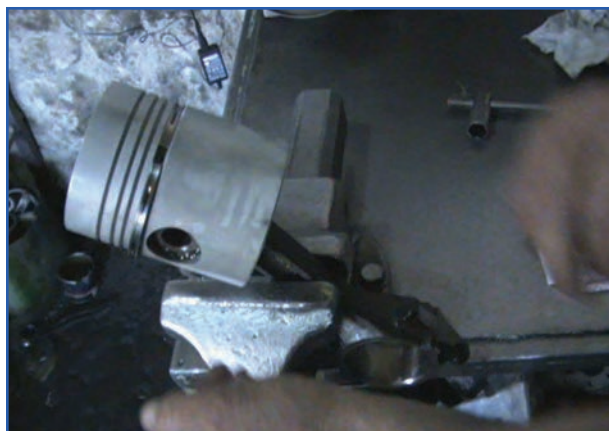
شکل ۱۳۷-۴- طرز بستن شاتون و پیستون به گیره
