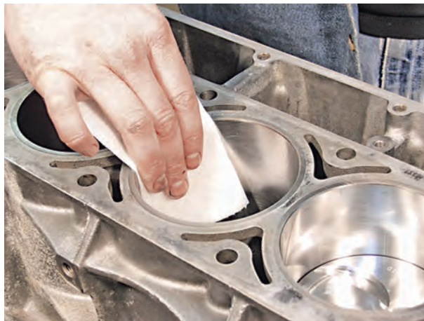
شکل ۲۰۸-۴- تمیز کردن داخل سیلندر
