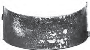
شکل ۱۶۸-۴ اثرات سوختگی روی یاتاقان
