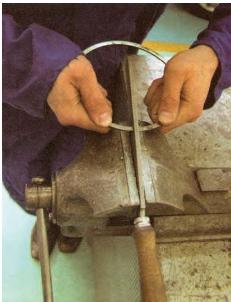
شکل ۱۳۰-۴- ساییدن دهانه رینگ با سوهان
