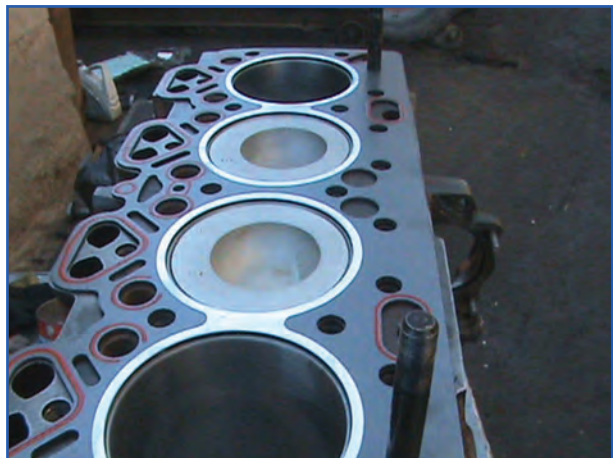
شکل ۵۲-۴- قرار دادن واشر سرسیلندر روی بدنه سیلندر
