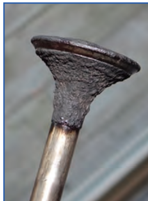
شکل ۴۵-۴- کربن گرفتن بشقابک سوپاپ
