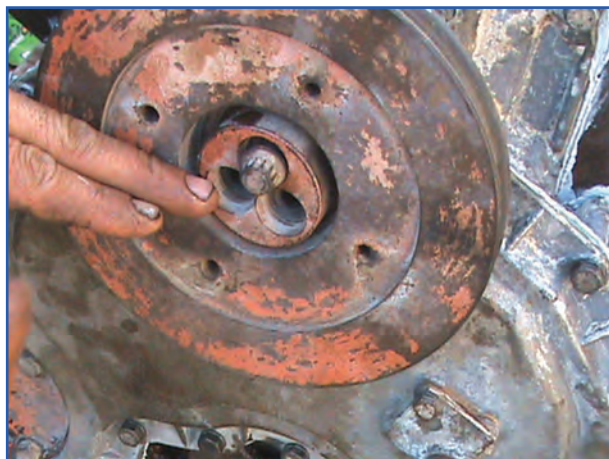
شکل ۴-۵۵- بستن پیچ سر میل لنگ تراکتور
