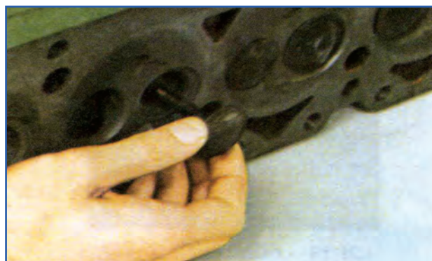
شکل ۲۳-۴- نحوه خارج کردن سوپاپ‌ها
