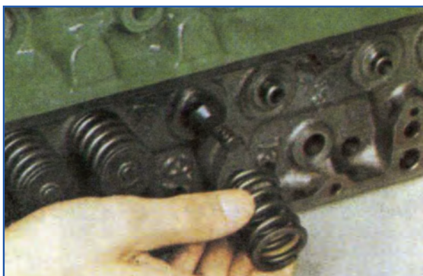
شکل ۲۱-۴- نحوه برداشتن فنر سوپاپ
