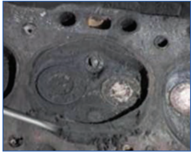
الف) کربن گرفتن سرسیلندر
