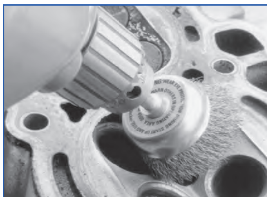
شکل ۴۱-۴- تمیز کردن اتاق احتراق
