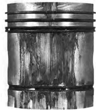
الف) خط و خش روی پیستون
