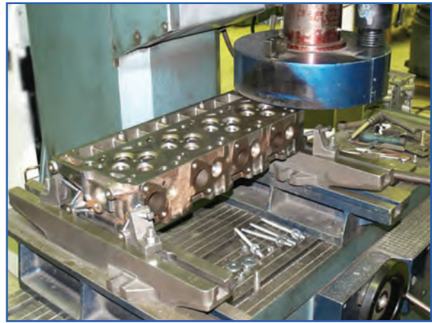
شکل ۳۲-۴- دستگاه کف تراشی سرسیلندر
