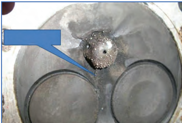
ج) ترک بین سوپاپ و انژکتور روی سرسیلندر
