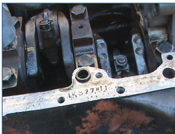
شکل ۸۲-۴- محفظه میل‌لنگ بدون بپمپ روغن
