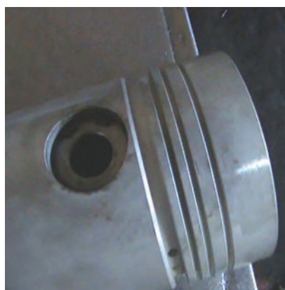
شکل ۱۲۳-۴ میزان داخل شدن انگشتی در پیستون
