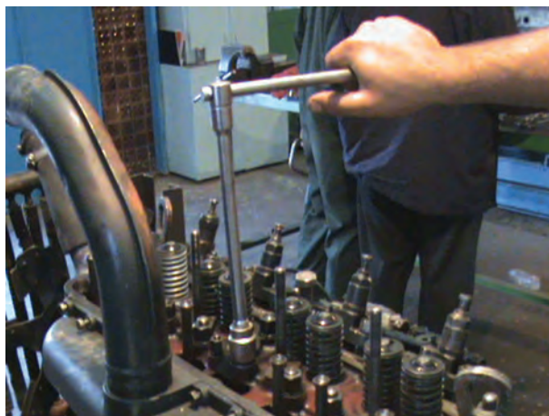
الف) باز کردن پیچ‌های سرسیلندر تراکتور U650
