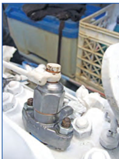
شکل ۵۴-۴- مراحل بستن انژکتور
