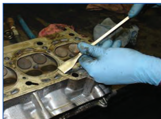
شکل ۴۲-۴- واشر سرسیلندر چسبیده به سیلندر
