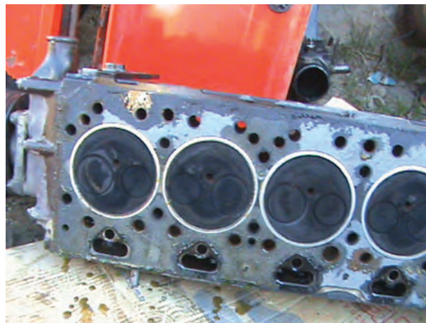
شکل ۱۵-۴- طرز قرار دادن سرسیلندر روی سطح صاف
