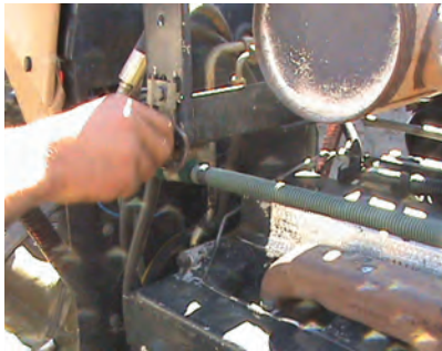
ج) باز کردن شاسی نگهدارنده رادیاتور
