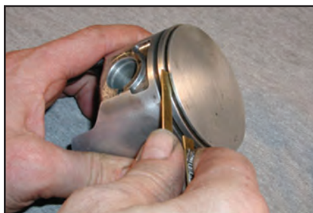
(د) تمیز کردن شیپار با ابزار برنجی
