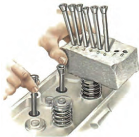
ب) به ترتیب قرار دادن میل تایپت
