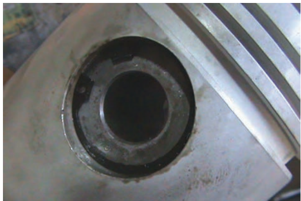
شکل ۱۲۵-۴- جا افتادن خار انگشتی در شیار پیستون
