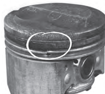
شکل ۴-۹۹- شکستن رینگ و تخریب جای رینگ
