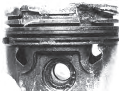
شکل ۴-۱۰۰- تخریب شدید جای رینگ
