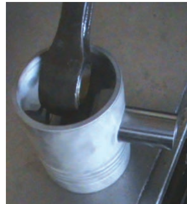
شکل ۱۲۲-۴ اتصال شاتون به پیستون و جازدن انگشتی
