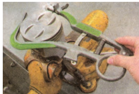
(ب) کاربرد ابزار تمیزکننده شیپار رینگ‌ها
