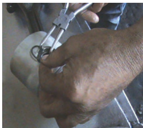
شکل ۱۲۵-۴ طرز جازدن خار انگشتی
