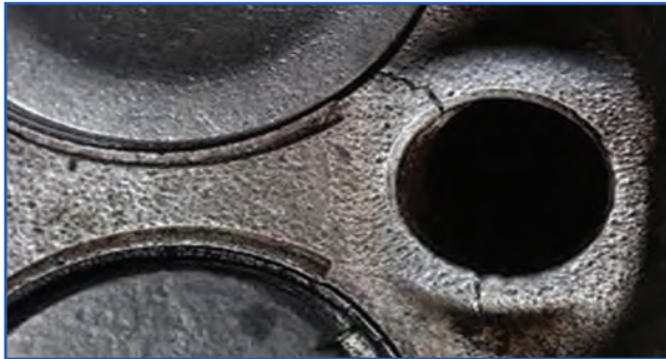
ب) ترک بین سیلندر و سوپاپ سرسیلندر
