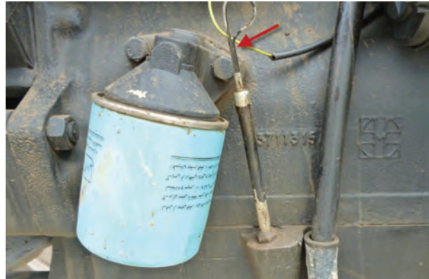
شکل ۳۰-۷- میله سنجش سطح روغن تراکتور MF285
