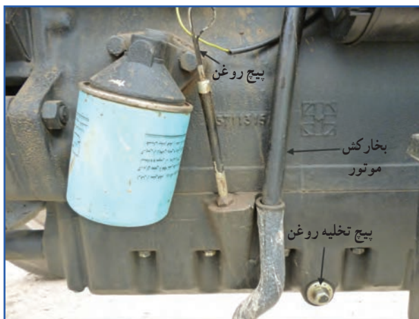
شکل ۲۷-۷- پیچ تخلیه روغن کارتر MF285
