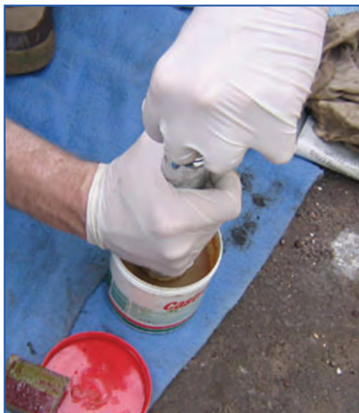
شکل ۴۸-۷- مراحل پر کردن گریس پمپ دستی
