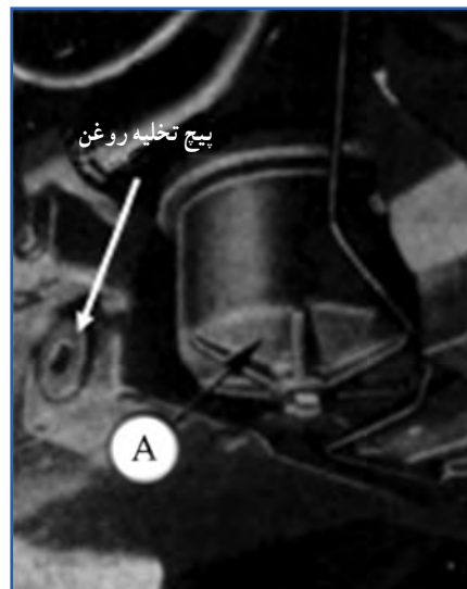
شکل ۵۷-۷ صافی روغن هیدرولیک در تراکتور جان‌دیر
