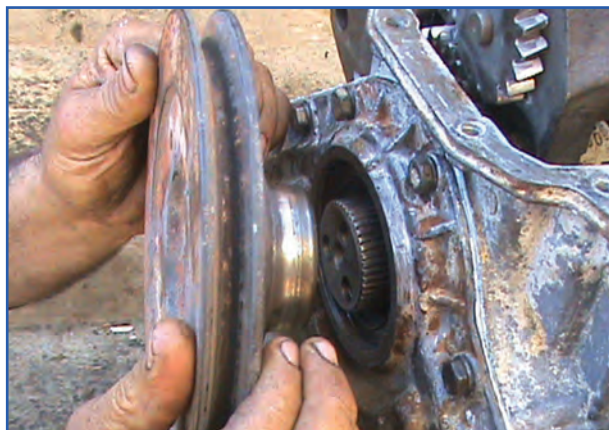
شکل ۴۶-۷- جازدن چرخ تسمه سر میل لنگ
