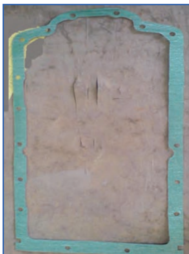
ب) واشر کارتر چوب‌پنبه‌ای MF285
