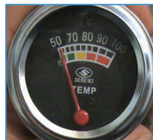
شکل ۱۰-۲- درجه نشان‌دهنده دمای آب
