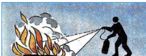
شکل ۱۳-۱- روش خاموش کردن آتش با پودر
