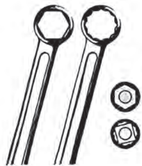
شکل ۳۰-۳- آچار رینگی با سر شش و دوازده گوش
