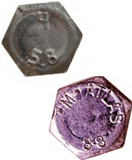
شکل ۱۵-۳ اعداد حک شده روی سر پیچ
