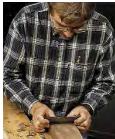
شکل ۲-۳۰. پرداخت سطوح قوس دار به وسیله لیسه.
