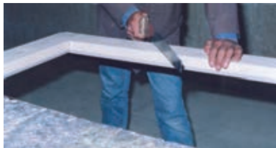
شکل ۱۱-۲۶- ایجاد شیار با اره‌ی دستی.
