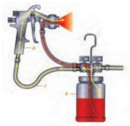
شکل ۴-۳۴- پیستوله با مخم کم.
