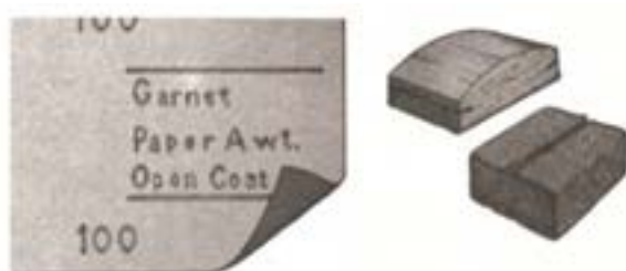
شکل ۷-۲۴- ورق سنباده استاندارد.
