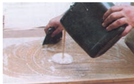
شکل ۴-۶. پفش کردن چسب به وسیله‌ی شانه‌ی چسب‌زنی.
