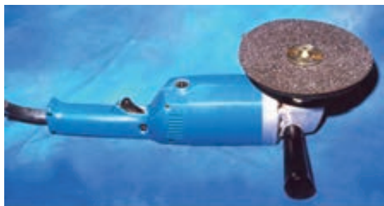
شکل ۷-۱۴- دستگاه سنباده دیسکی (ماشین پوست).
