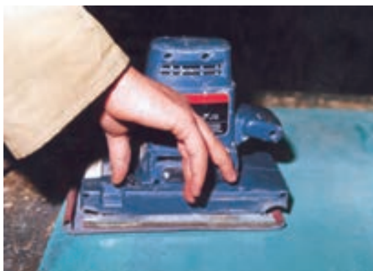
شکل ۷-۱۳ - با جابه جایی ضامن ها، فک ها نیز حرکت می کنند.
