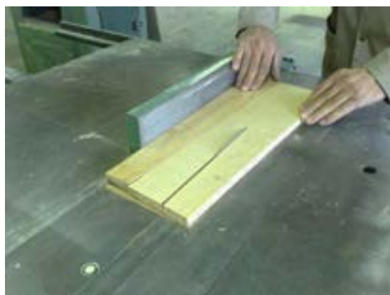
شکل ۱۲-۱۳. برش پایه‌ها با اره گرد مفصوص MDF.
