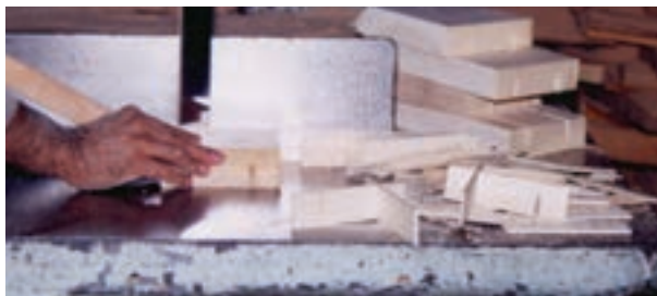
شکل ۱۱-۳۱- تولید شبکه‌های داخل در.
