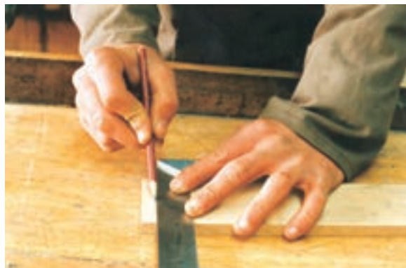
شکل ۹-۶۸- فم کشی ممل اتصال با گونیا.
