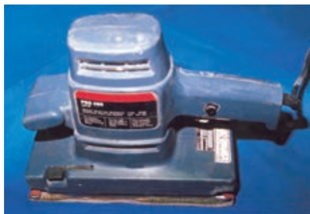
شکل ۷-۹. دستگاه سنباده لرزان.
