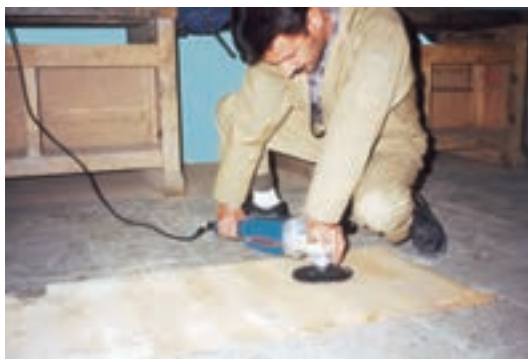
شکل ۷-۴۱- خم شدن (روی دستگاه به فرد سنباده کار و دستگاه آسیب می‌رساند).
