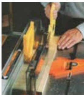
شکل ۱۲-۳- استفاده از وسایل کمکی در هنگام کار.
