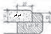
مقطع سنگ مرمر، با پر کردن نقطه در سطح ضخامت آن نمایش داده می شود.
