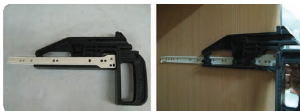
شکل ۲۷-۷ گونبای مخصوص نصب ریل
