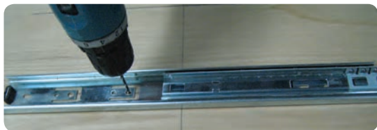
شکل ۷-۳۳ سوراخ‌کاری محل استقرار ریل روی بدنه فایل
