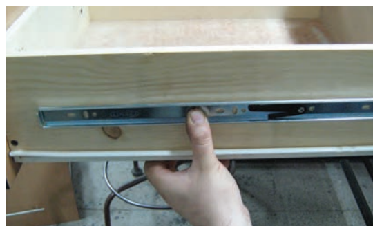
شکل ۷-۳۵ تعیین محل ریل بر روی بدنه‌ی کشو
