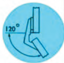
شکل ۷-۱۳- ب انواع لولای کابینت بدون فنر
