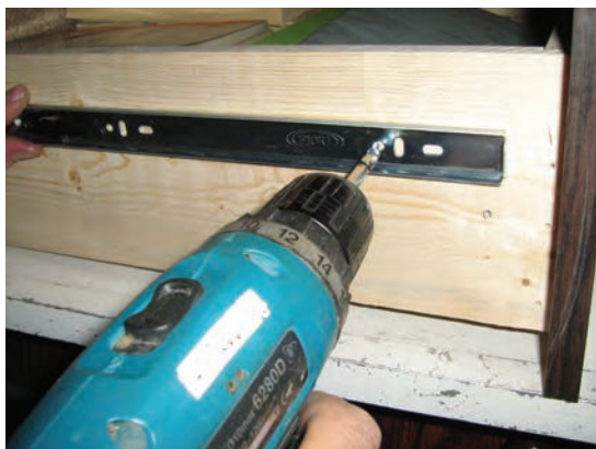
شکل ۷-۳۶ نصب ریل بر روی بدنه‌ی کشو
