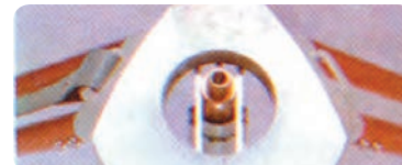
شکل b-۸-۱۲- پیچ روی سه پایه
