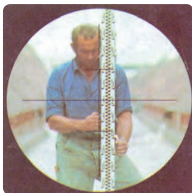
شکل ۱۴-۸ — طریقه‌ی نگاه داشتن میر
