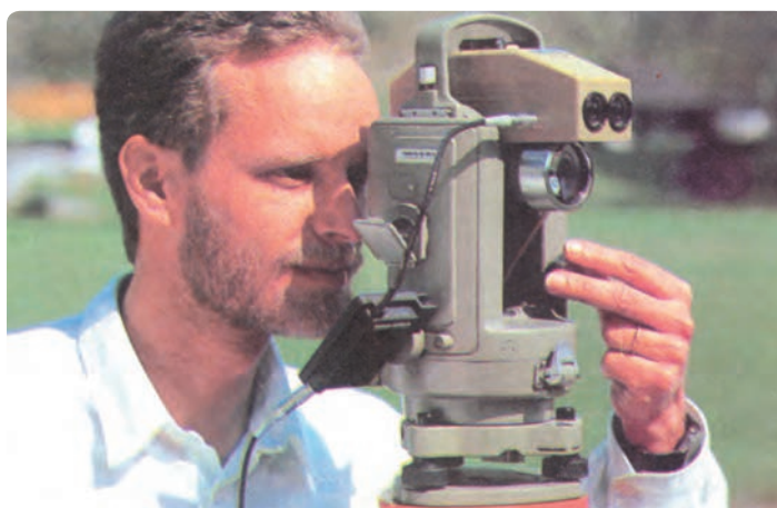
شکل ۴-۲۳ نصب فاصله‌یاب روی دوربین
