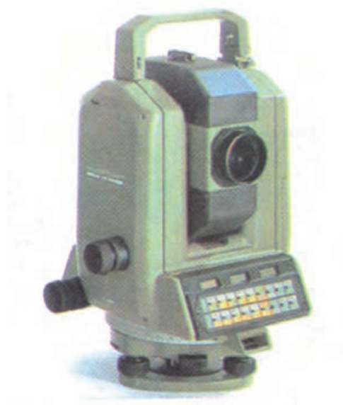
شکل ۴-۲۴ فاصله‌یاب در داخل دوربین نقشه‌برداری
