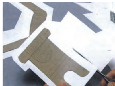
۱- خطوط محیطی الگو روی ورق پلاستیکی رسم می شود.
