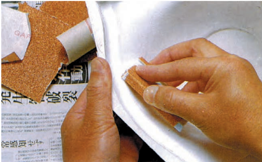
۱۳- زیربهای سطح قالب گچی را پس از خشک شدن گچ با سنباده برطرف کنید.
