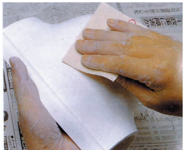
۲۰- سطح خارجی قطعه را پس از خشک شدن به آرامی با یک تکه سنباده بسایید.
