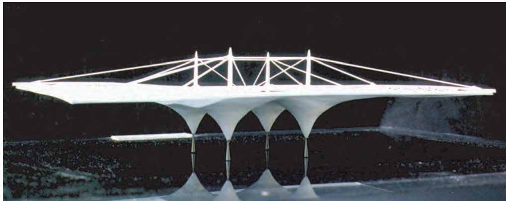
شکل ۳۲- مدل پوسته‌ای با فایبرگلاس
