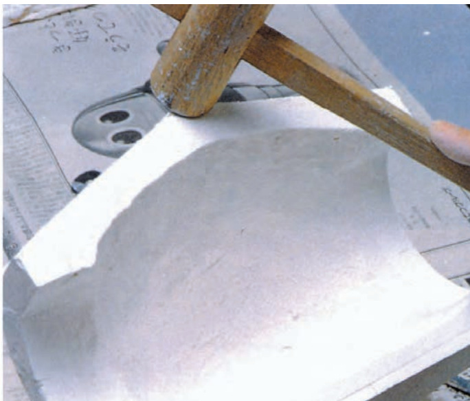
۱۹- پس از گرفتن گچ، با چکش به آرامی و با دقت قالب را شکسته و قطعه را خارج سازید.
