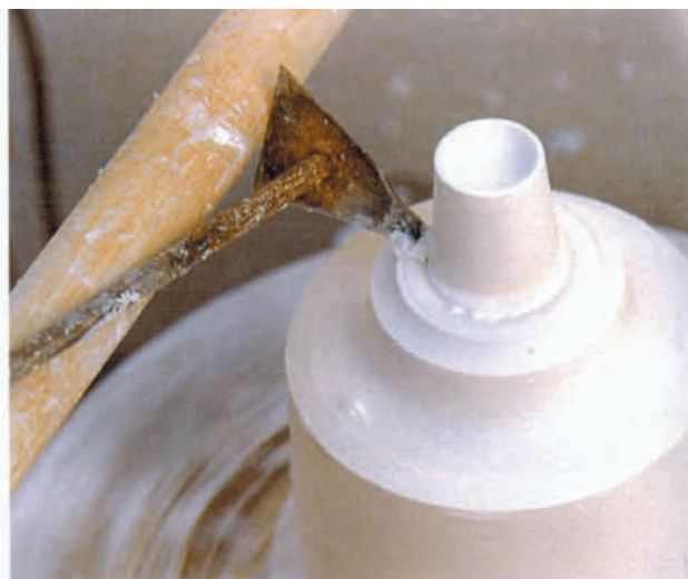
۹- مشخص کردن ارتفاع دقیق
