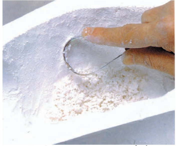
۱۸- قبل از آن که گچ به طور کامل سفت شود با تیغه ای کمانی شکل و دنداندار، سطوح ناخواسته را بتراشید.
