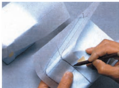
۳- برای به دست آوردن انحناها، یک کاغذ ترسیم (کالک) روی قسمتهای منحنی شابلون بلوفومی گذارده می شود و خطوط انحنا برای رسم گسترده مدل پلاستیکی ترسیم می گردد.
