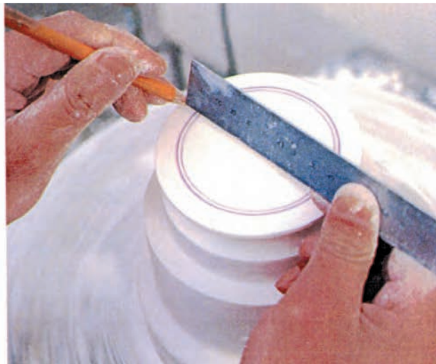
۱۳- گچ گذاری روی پایه - تراشیدن و اندازه گیری برای تراشهای بعدی
