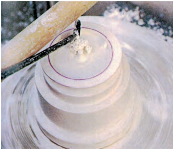
۱۴- تراش گچ گذارده شده روی پایه مایع جدا کننده خورده
