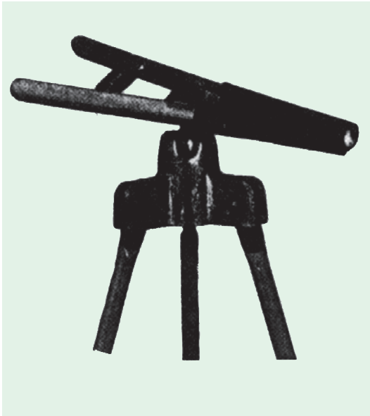
شکل ۳-۳- ژالون گیر و نحوه‌ی به کارگیری آن
