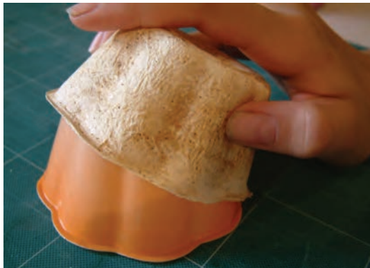
۴- خروج قطعه از روی مدل
