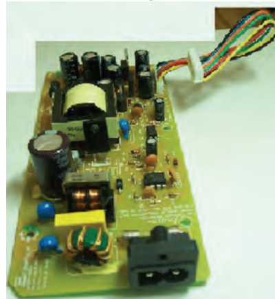
شکل ۷-۱۳ قرار گرفتن ورودی‌ها در یک طرف و خروجی‌ها در طرف دیگر
