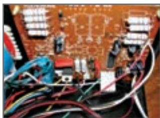
شکل ۱۳۲- برد الکترونیکی و کنترل شدت هوای فشرده
