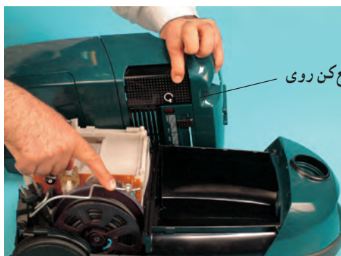
رابط میله‌ای اهرم ضامن سیم‌جمع‌کن شکل ۶-۲۰۷
