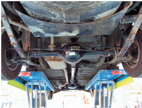
شکل ۳۱۵- دیفرانسیل در خودرو محرک عقب
