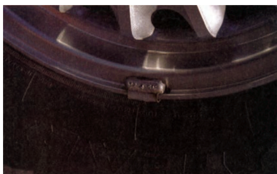
شکل ۳-۲۳۱- نصب وزنه روی رینگ
