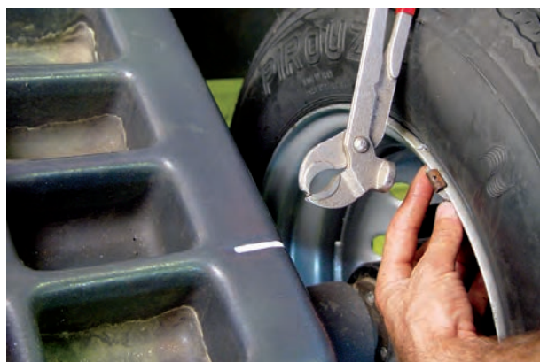
شکل ۲۳۹-۳- نصب وزنه روی قسمت داخلی رینگ
