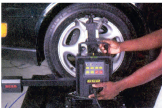
شکل ۳-۲۲۰ - نصب مجموعه حسگر دستگاه اندازه‌گیر رایانه‌ای
