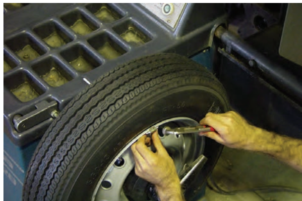
شکل ۲۳۸-۳- نصب وزنه روی قسمت بیرونی رینگ
