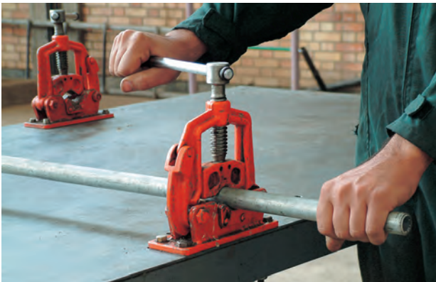
شکل ۳-۵۳- باز کردن شاخه‌ی لوله از گیره‌ی لوله
