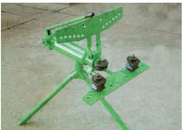
شکل ۳-۴۸- قرار گرفتن لقمه در محل مناسب خود
