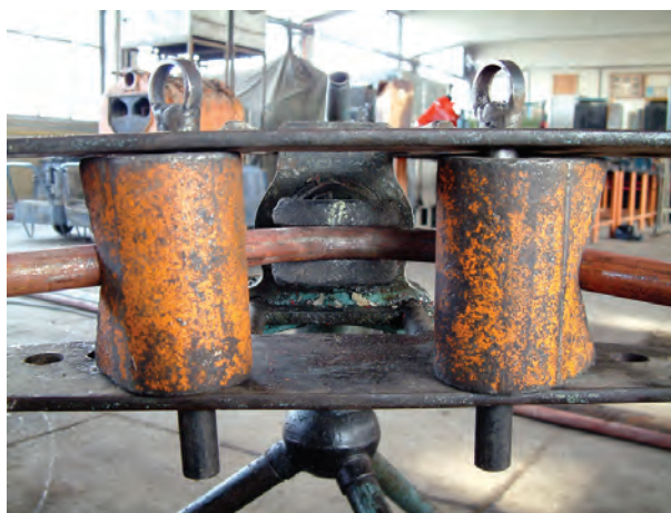
الف- باز کردن خم لوله‌ی خم شده
