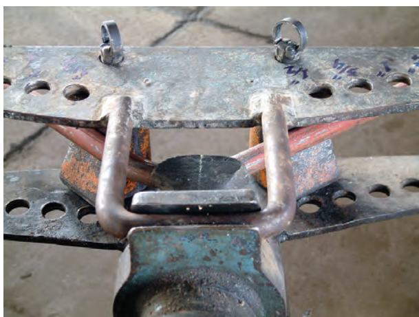
ب- باز کردن خم لوله‌ی خم شده
