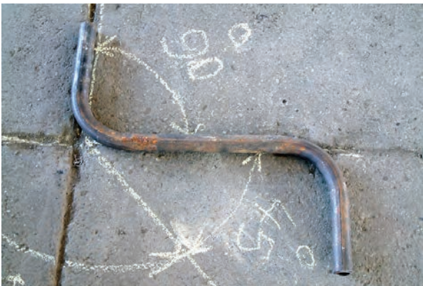
شکل ۳-۴۱- عدم دویدگی لوله‌ی دو خم
