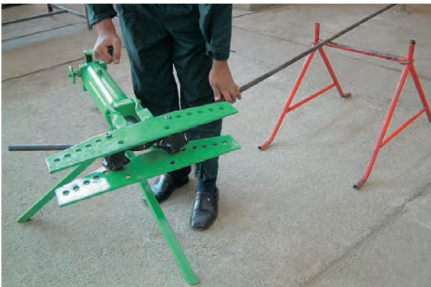
شکل ۳-۴۲- استفاده از خرک در خم کاری
