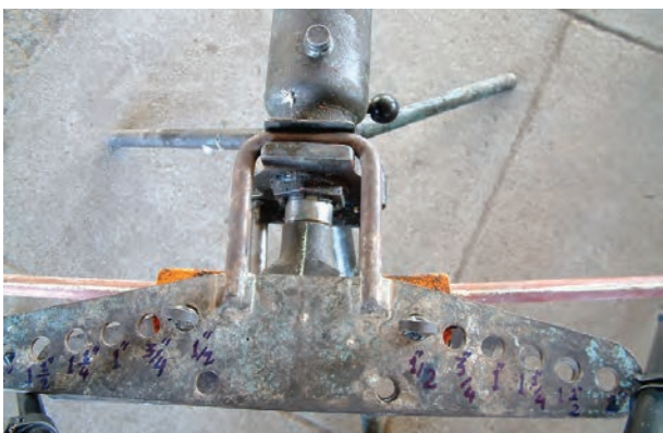
شکل ۳-۵۰- درز لوله در سمت بالا قرار گرفته است.
