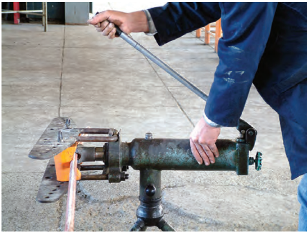
شکل ۱۱-۳- شروع خم کاری
