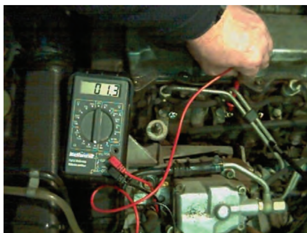
شکل ۲۱-۱۳- اندازه گیری مقاومت شمع گرم کن سیلندر دوم موتور
