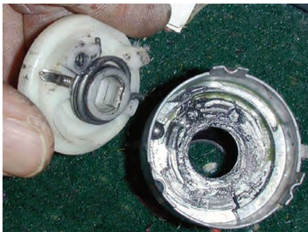
شکل ۲۱-۱۱- بیرون آوردن فیبری زیرین از داخل محفظه‌ی فلزی
