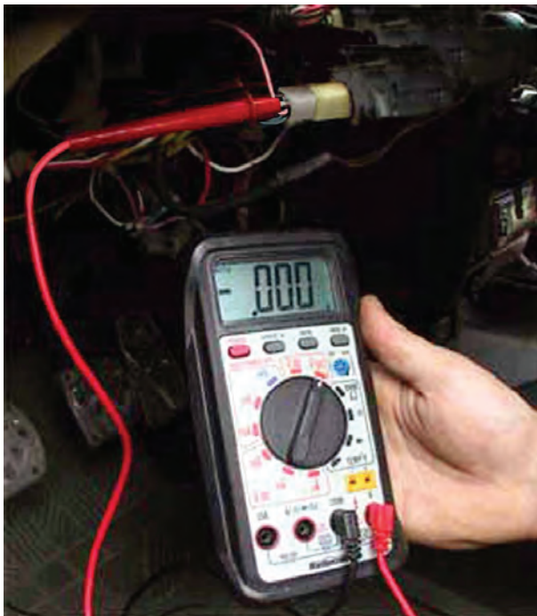
شکل ۲۹-۱۱- اتصال سیم مثبت مولتی متر به سیم ترمینال ACC فیبری
