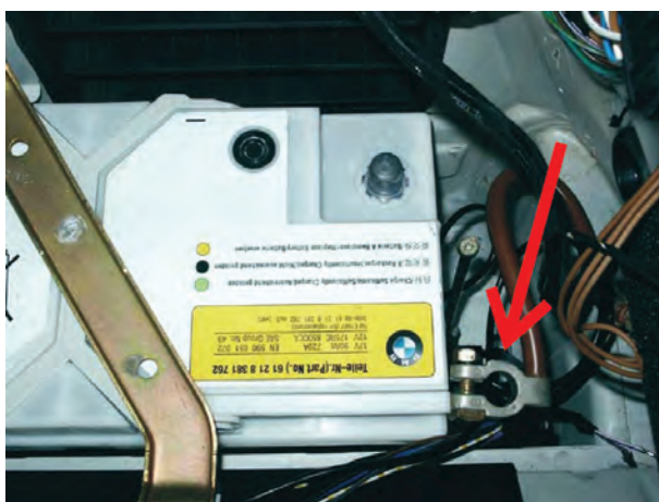
شکل ۹-۱۱- باز کردن کابل اتصال بدنه ی باتری
