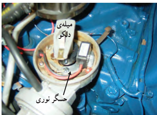
شکل ۱۴۵-۲- سه نمونه حسگر استفاده‌شده در سیستم جرقه‌زنی
