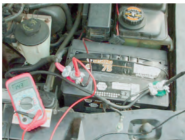
شکل ۷-۱۰۲- اندازه‌گیری ولتاژ شارژ
