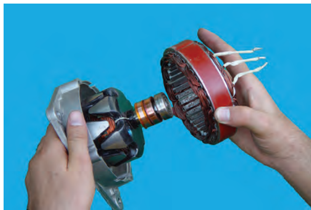
شکل ۶۲-۷ - جدا کردن استاتور
