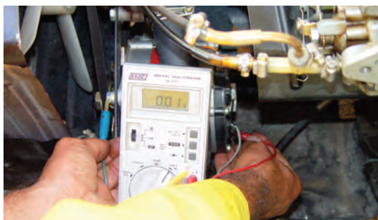
شکل ۷۲-۷ - اتصال ولت‌متر بین ترمینال B و بدنه
