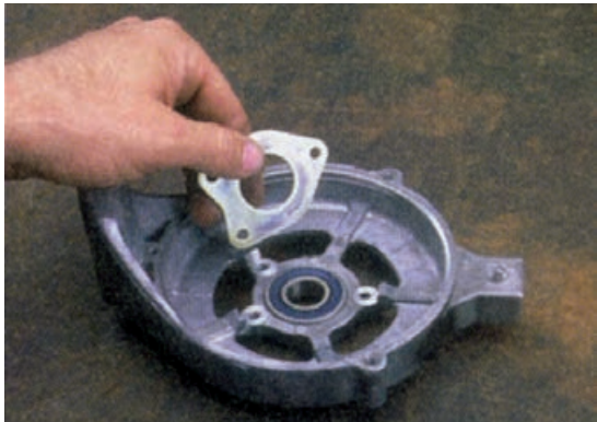
شکل ۶۸-۷ - در آوردن نگهدارنده‌ی بلبرینگ
