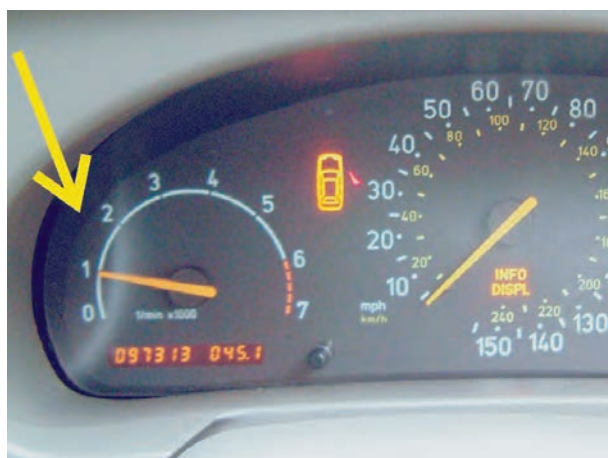
شکل ۷-۱۰۰- حالت دور آرام موتور
