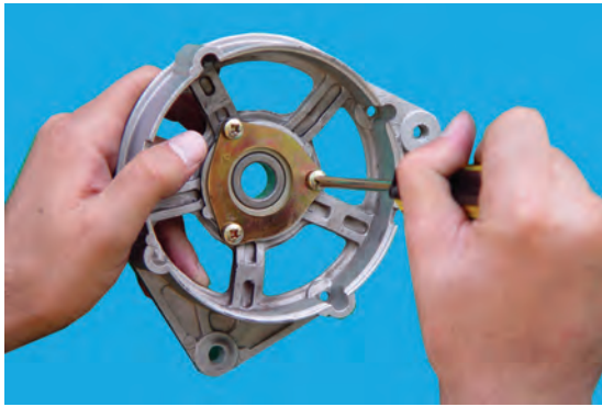
شکل ۶۷-۷ - باز کردن پیچ‌های نگه‌دارنده‌ی بلبرینگ
