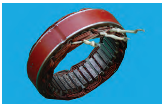
شکل ۷-۳۷- استاتور با سرپیچ های خروجی
