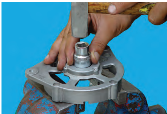
شکل ۶۹-۷ - بیرون آوردن بلبرینگ
