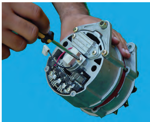
شکل ۷-۵۳ بازکردن پارازیت گیر
