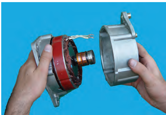
شکل ۶۱-۷ - جدا کردن درپوش‌های آلترناتور
