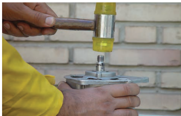
شکل ۶۳-۷ - بیرون آوردن روتور از درپوش
