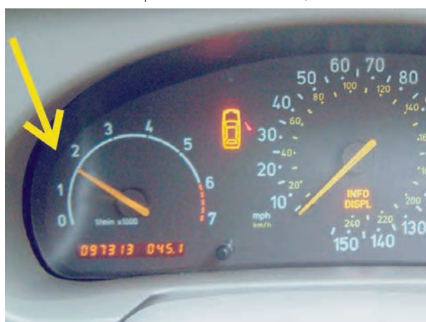
شکل ۷-۱۰۱- افزایش دور موتور برای آزمایش
