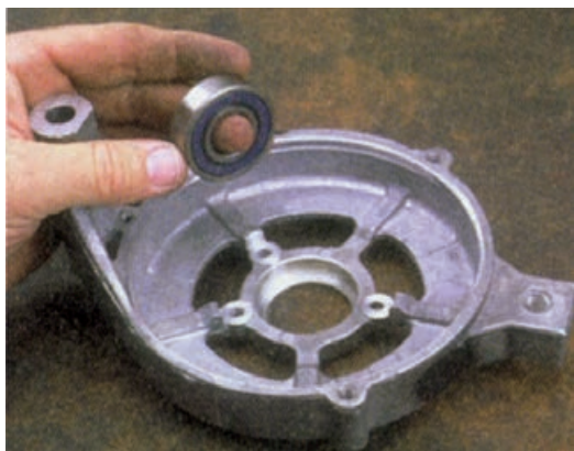
شکل ۷۰-۷ - خارج کردن بلبرینگ و آزمایش آن
