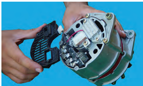
شکل ۷-۵۲ بازکردن درپوش دیودها
