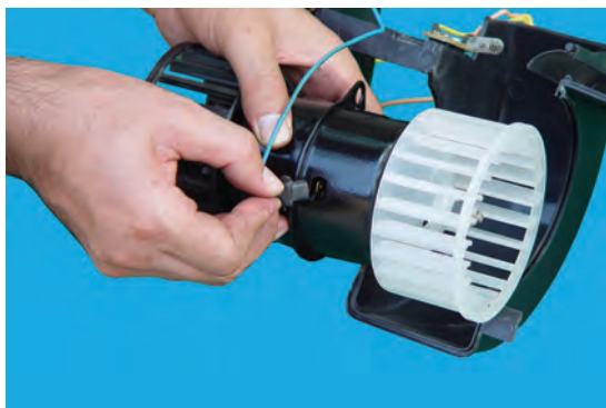
شکل ۴-۴۱- جدا کردن سیم از زغال‌ها
