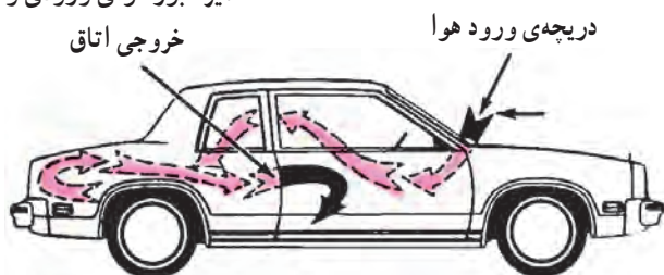
شکل ۱۱-۴- مسیر عبور جریان هوای گرم در خودرو
