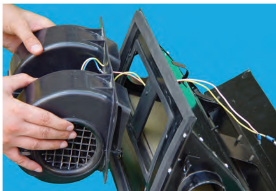
شکل ۴-۳۷- جدا کردن محفظه‌ی موتور از بخاری
