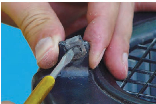
شکل ۴-۳۸- باز کردن ضامن خار
