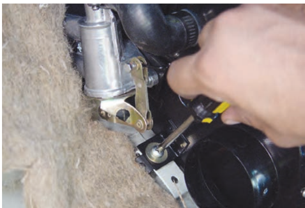
شکل ۴-۳۳- پیچ های پایه ی بخاری
