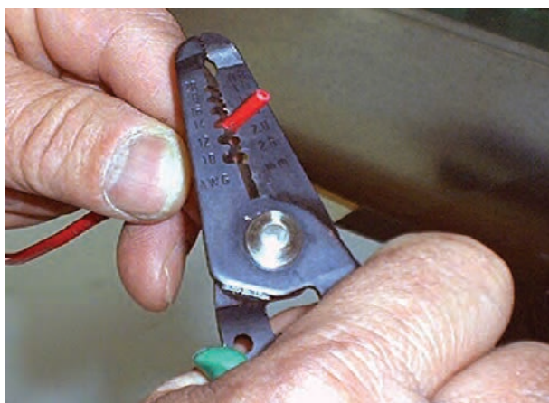
شکل ۴-۶۴- جدا کردن عایق سیم‌ها
