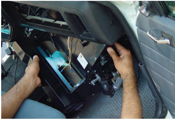
شکل ۴-۳۴- خارج کردن بخاری از محل نصب آب
