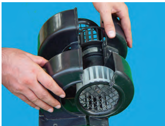
شکل ۴-۴۰- جدا کردن محفظه‌ی نگهدارنده‌ی موتور
