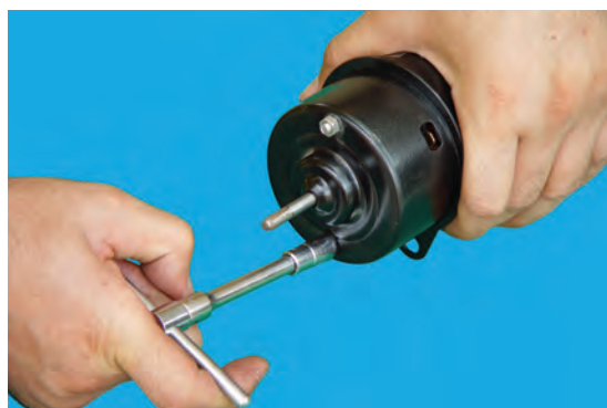
شکل ۴-۴۴- باز کردن پیچ‌های پوسته‌ی موتور
