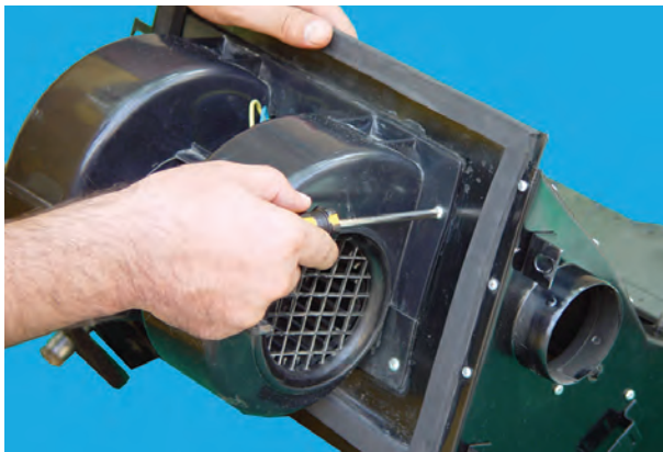
شکل ۴-۳۶- باز کردن پیچ‌های محافظه‌ی موتور
