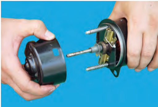
شکل ۴۵-۴ جدا کردن پوسته‌ی موتور
