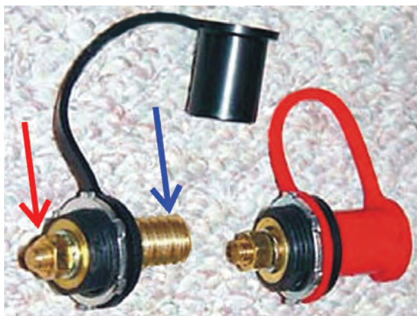
شکل ۱۴-۲- واسطه‌ی اتصال ترمینال باتری
