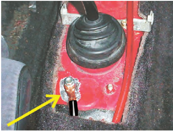
شکل ۲-۲۵- اتصال بدنه‌ی باتری در داخل اتاق خودرو
