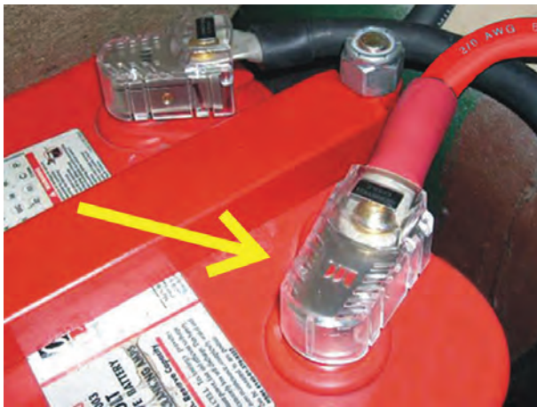
شکل ۱۹-۲- مورد استفاده تلق محافظ قطب‌های باتری
