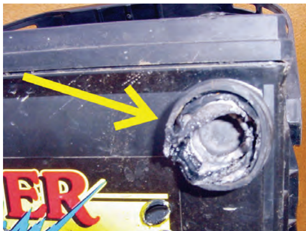
شکل ۲-۳۶- معیوب بودن ترمینال باتری
