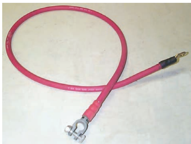
شکل ۳۲-۲- کابل اتصال مثبت باتری
