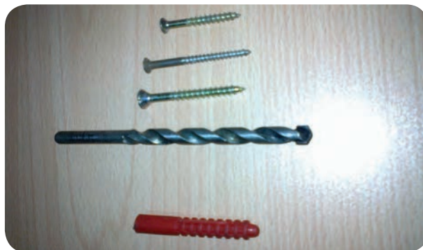
شکل ۶-۵ - مته الماسه، رولپلاک و پیچ های مناسب کار
