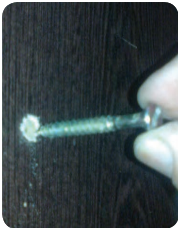
شکل ۲-۶- میله پیچ باید به راحتی از سوراخ ایجاد شده، عبور کند.
