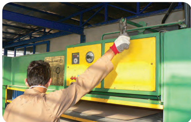
شکل ۹۵-۵- اهرم باز کردن صفحات پرس
