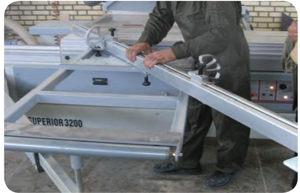
شکل ۵-۵۱- تنظیم گونیا یا تکیه‌گاه برای برش کج صفحات
