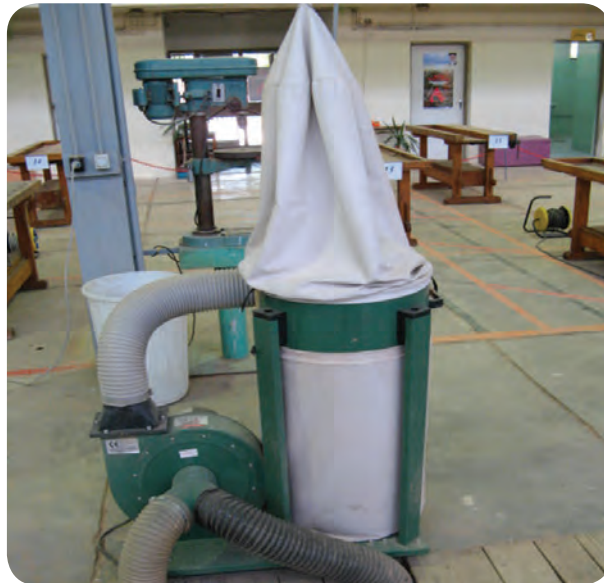
شکل ۲۴-۵- خروج ضایعات از طریق کانال پوشیده شده
