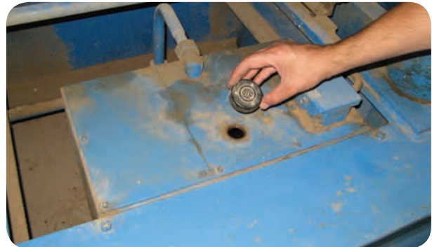
شکل ۸۸-۵- کنترل و تعویض روغن هیدرولیک مخزن
