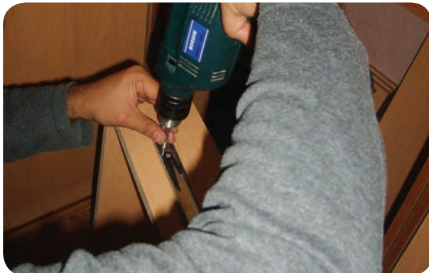
شکل ۱۷۶-۵- نصب ریل تکی به بدنه کشو
