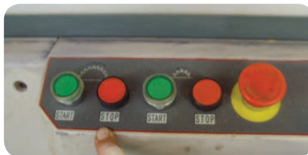
شکل ۵-۶۰- کلید خاموش و روشن کردن ماشین دورکن
