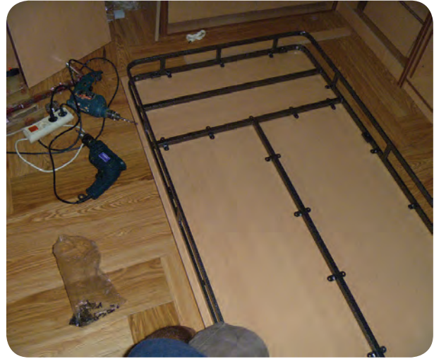
شکل ۱۳۰-۵- استقرار کلاف فلزی روی صفحه جلو تختخواب
