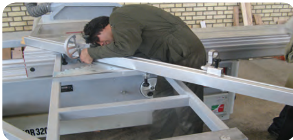
شکل ۵-۵۰- تنظیم دو کفشک کنترل اندازه‌گیری
