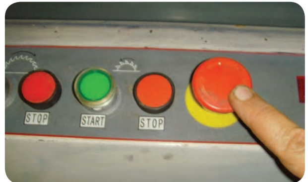
شکل ۵-۶۷- کلید خاموش کردن کلی ماشین دور کن
