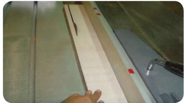
شکل ۱۰۴-۵- خطر پس‌زدن و پرتاب قطعه وجود دارد
