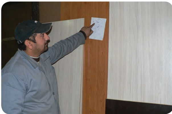
شکل ۵-۶۶- نصب اندازه‌های برش نزدیک ماشین دورکن
