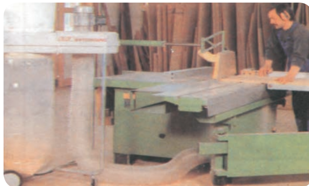
شکل ۲۵-۵- استفاده از حفاظ و تجهیزات ایمنی
