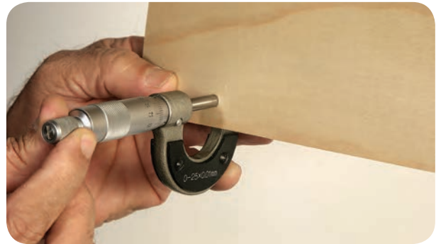
شکل ۷۲-۵ اندازه‌گیری ضخامت روکش با میکرومتر
