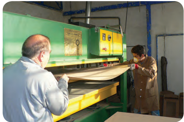
شکل ۵-۹۶- خارج کردن صفحات پرس شده
