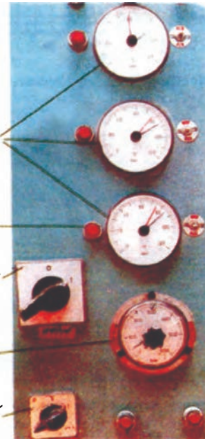
شکل ۸۷-۵- تنظیم اجزای پرس برای چسباندن روکش
