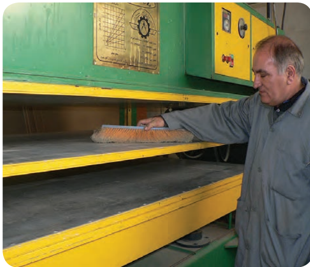
شکل ۵-۹۸- تمیز کردن پرس در پایان کار
