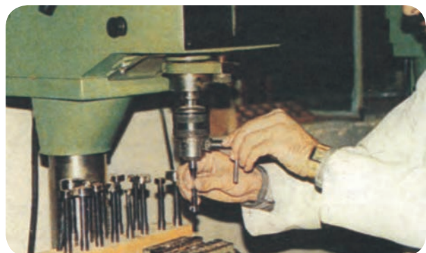
شکل ۳۱-۵- آچار سه‌نظام و گیره نگاه‌داشتن قطعات کوچک در ماشین دریل ستونی
