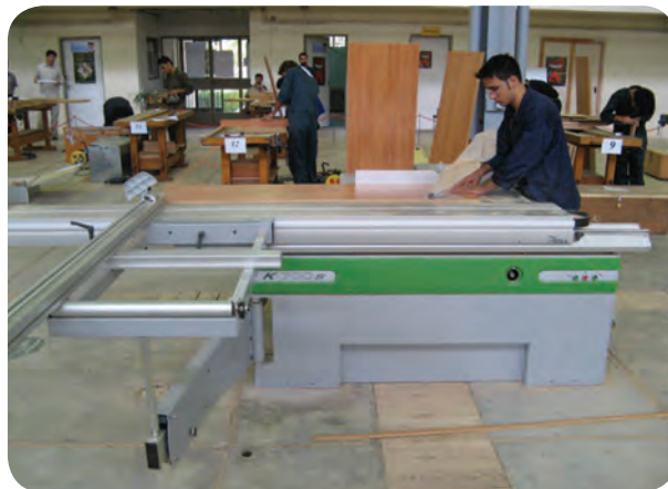
شکل ۱۱۵-۵- برشکاری قطعات سقف و کف
