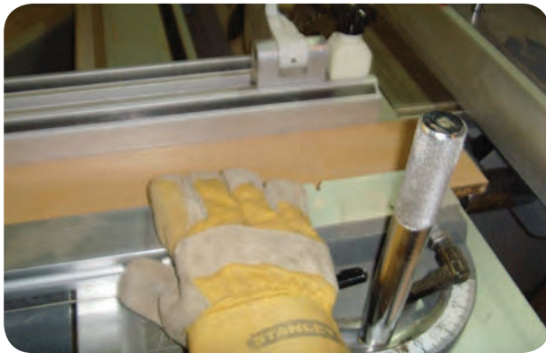
شکل ۱۰۷-۵- استفاده از گونیای کشویی میز متحرک ماشین اره پانل‌بر
