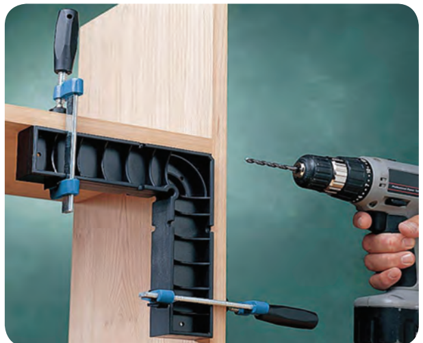
شکل ۱۷۰-۵- استفاده از شابلون برای جلوگیری از دوئیدگی
