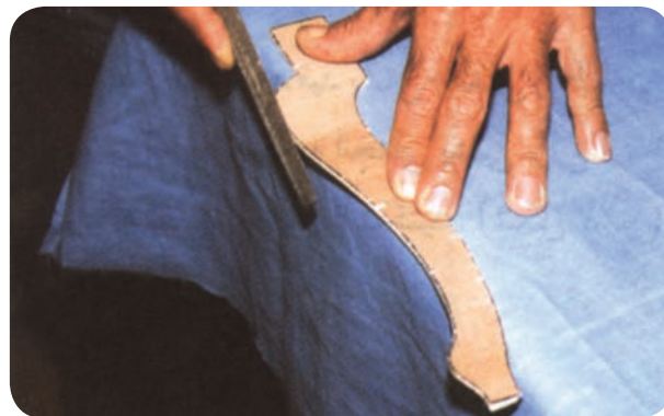
شکل ۵-۲۱- تهیه شابلن خط‌کشی برای ساخت پایه
