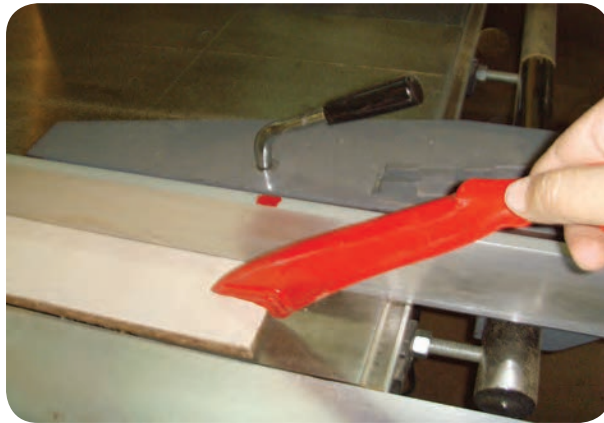
شکل ۵-۶۵- استفاده از وسیله کمکی هدایت قطعه باریک
