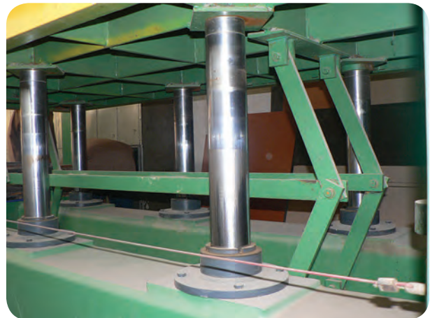
شکل ۸۹-۵- کنترل پیستون و سیلندرهای پرس
