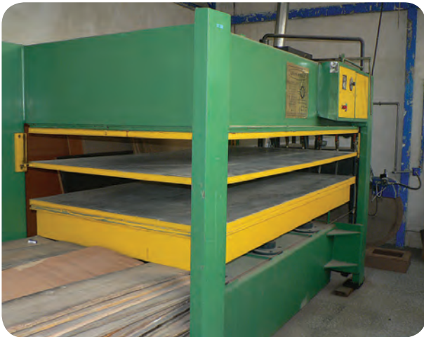
شکل ۷۵-۵ پرس سه طبقه روغنی هیدرولیک گرم
