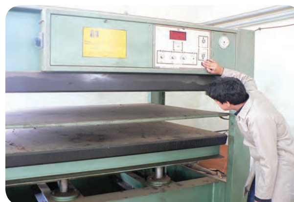
شکل ۸۵-۵- کنترل کار کردن صحیح پرس
