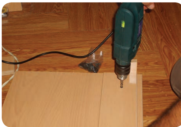
شکل ۵-۱۴۶- آماده‌سازی بدنه کمد لباس و نصب مانع
