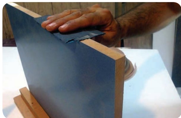
شکل ۴-۴۶ - سنباده زدن نوک کار
