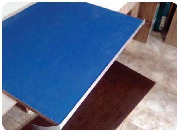
قرار دادن قطعه کار نوار شده در لبه میز
