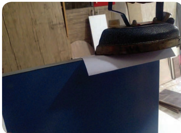
شکل ۴-۴۸- حرکت اتو در روی قطعه کار
