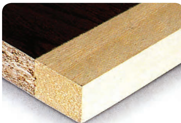
شکل ۴-۳- استفاده از چوب، به منظور لبه چسبانی
