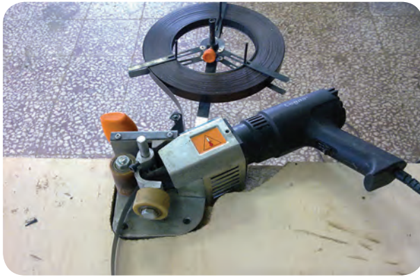
شکل ۴-۲۱ - نحوه استقرار سشوار روی میز
