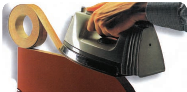
شکل ۴-۱۶ - نوار کردن لبه‌های قوس‌دار توسط اتو
