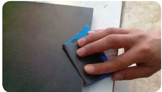
شکل ۴-۳۰ - پرداخت لبه لبه‌های نوار شده با سنباده
