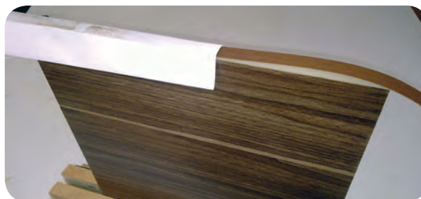
شکل ۴-۱۴ - نحوه استفاده از کاغذ در زیر اتو
