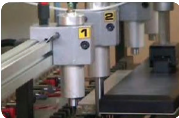
شکل ۳-۷ - قطعه کار، توسط جک‌ها گونیا شده است.
