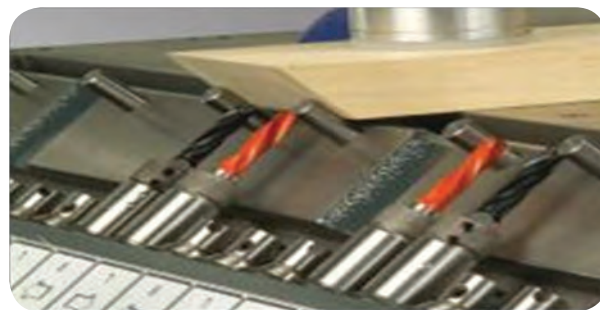
شکل ۳-۵ - سوراخ کاری قطعات زاویه دار
