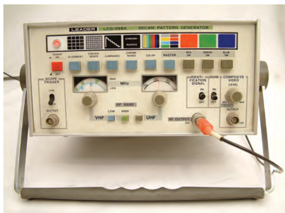
شکل ۱۶۳-۲- نمونه‌ای از پترن ژنراتور رنگی
