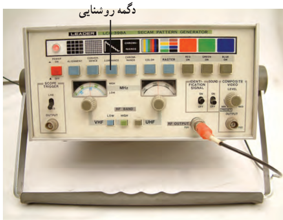
شکل ۱۷۱-۲ دگمه درروی پترن ژنراتور
