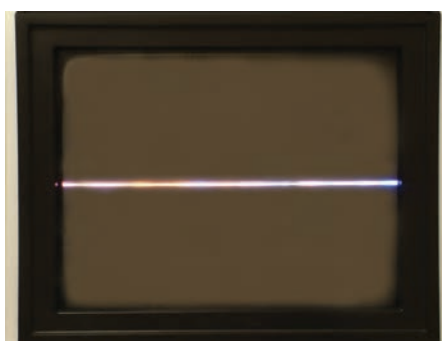
شکل ۲-۴۰- نوسان ساز عمودی از کار افتاده است.
