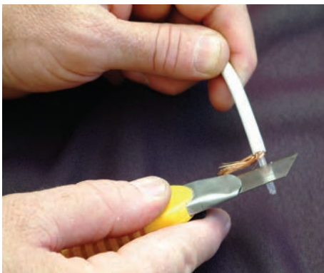
شکل ۱-۶۱- در بریدن کابل باید دقت شود.
