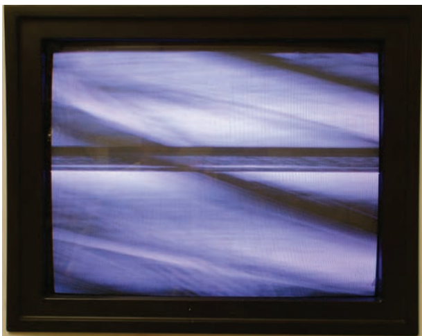
شکل ۱-۴۹ عدم تنظیم فرکانس نوسان ساز افقی
