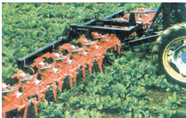
شکل ۶-۴- استفاده از کولتیواتور دوار در زراعت چغندر قند
