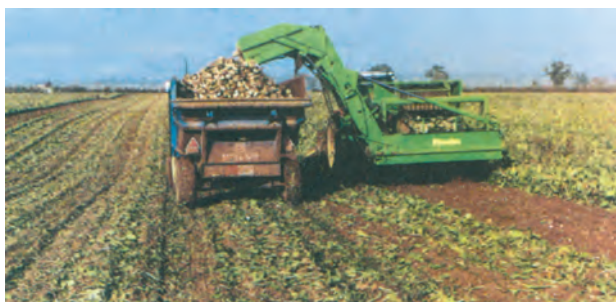
شکل ۱۶-۵- برداشت مکانیزه چغندر قند در دو مرحله (کندن، سرزدن) و بارگیری
