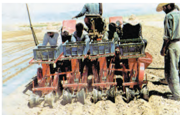
شکل ۱۲-۳- کاشت نشاها با ماشین نشاکار
